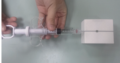
图1 造影剂注射剂量信号检测装置
